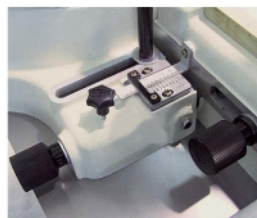
Freseanlegg med fininnstilling
