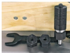
30 mm fresespindel og spennhylsechuck for Ø 8 og 12
