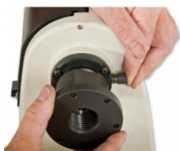
Spindellås for enkelt verktøyskift
