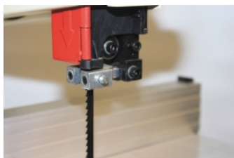
Bladstyre med lager og styrestifter
