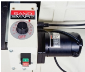
Trinnløs matning med Sandsmart
