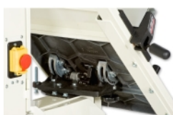
Doble svingsegment med ratt for skråstilling
