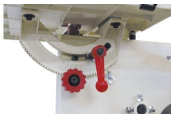
Skråstillbart bord med tannkrans og hånddratt
