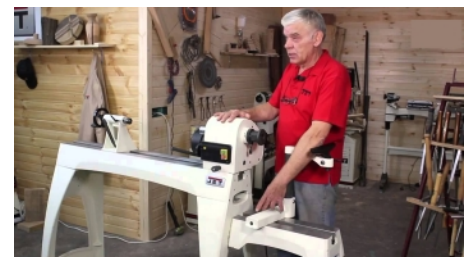
Vangeforlengelse monteret i nedre posisjon på understell for dreieing av stor diameter
