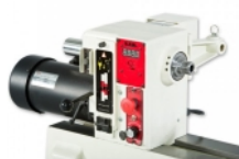
Bryterpanel med start/stopp turtall/revers
