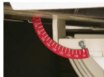
Gradskala for skråstilling av pussehodet
