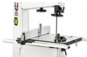
Kløvanlegg med styrepinne og gjæringsanlegg i T-spor
