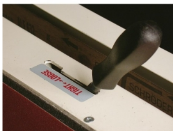
Låsespak for remspenning for enkelt bytte av pussebånd
