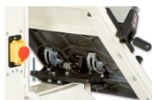
Doble svingsegment med ratt for skråstilling
