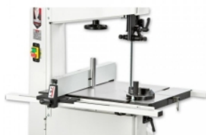
Kløvanlegg med styrepinne og gjæringsanlegg i T-spor
