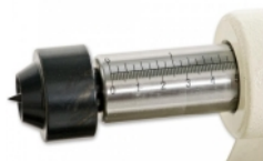
Gradert pinol med stor vandring
