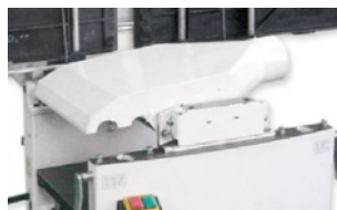
Avsughette dekker hele kutteren og har innebygget sikkerhetsbryter
