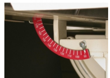
Gradskala for skråstilling av pussehodet
