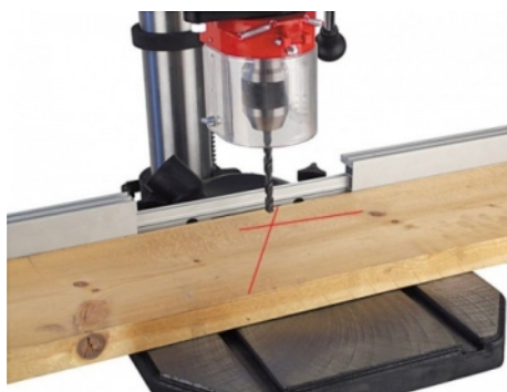
Krysslaser som viser borepunktet
