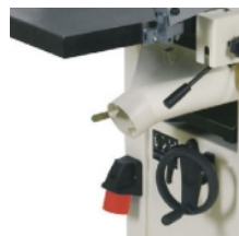
Hånddratt for hev/senk og hendel for matning
