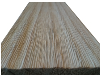
Eksempel på strukturering med stålbørste Myk furu, 1 forløp
