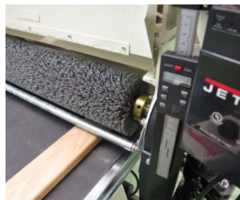
Fri tilgang til pussevalsen for enkelt båndskift
