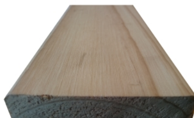
Eksempel på strukturering med nylonbørste Myk furu, 1 forløp
