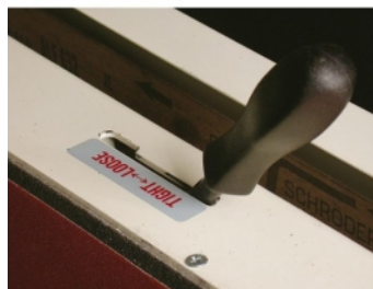
Låsespak for remspenning for enkelt bytte av pussebånd
