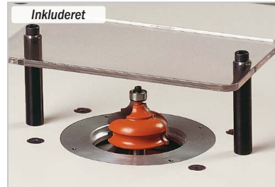
999.501.06_Beskyttelsesplade til at gøre frihåndsarbejdet mere sikkert.
