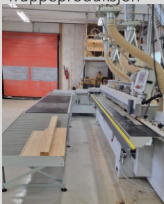
Eksempel installert på Langzauner pussemaskin Trappeproduksjon
